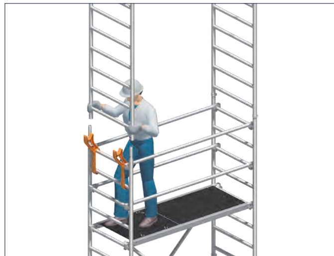
2. Standleiter mit Geländer nach oben schwenken und aufstecken.
