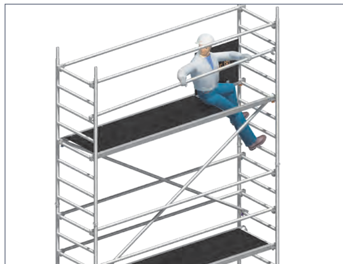
4. Montage der Zwischengeländer aus gesicherter Position im Bereich der Durchstiegsklappe.
