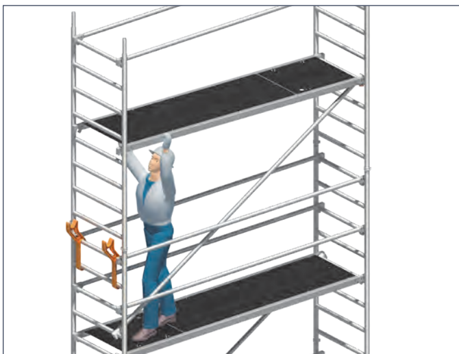
3. Diagonalen und Durchstiegsbrücke einsetzen.
