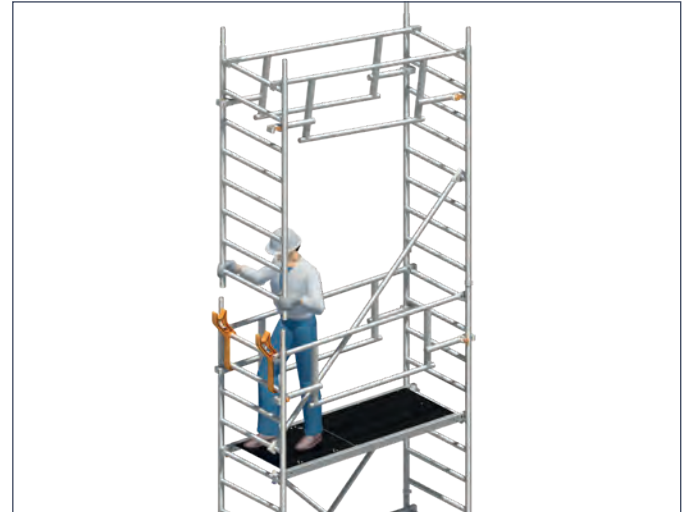
2. Standleiter mit Doppelgeländern nach oben schwenken und auf unterer Standleiter aufstecken.
