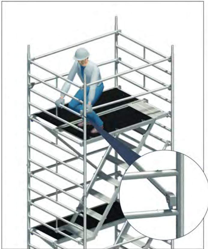
2. Einseitiges Lösen und Auflegen der Einrastklauen von beiden Zwischengeländern in 0,5m Höhe.
