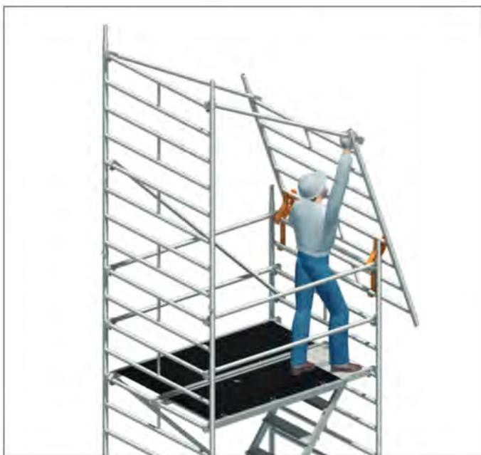
1. Einseitiges Aufstecken einer Standleiter 2 m 4a in die dafür vorgesehenen Rohrverbinder der Standleiter und mittels Federstecker 12 sichern.
