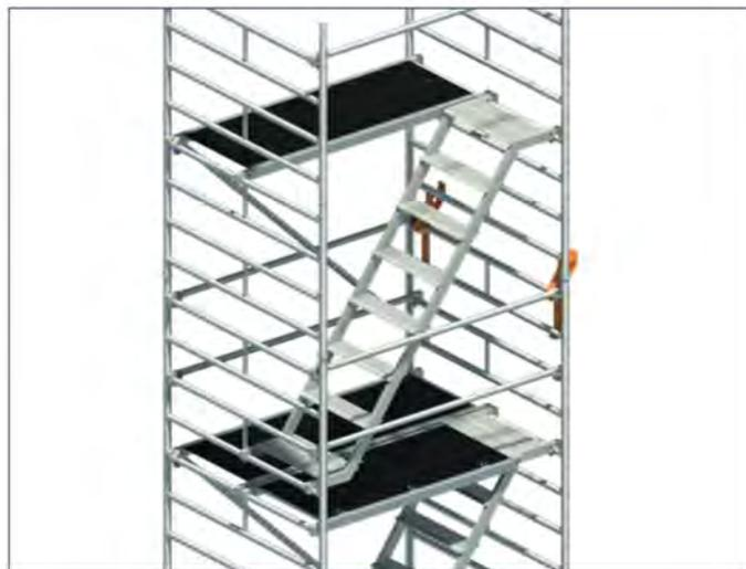
5. Die in den Montagehaken 21 positionierte Standleiter 2 m 4a durch nach oben schwenken in die Rohrverbinder der Standleiter Aufstecken und mittels Federstecker 12 sichern.
