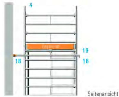
Für Arbeiten, die an einer tragfähigen Wand ausgeführt werden, kann die Ballastierung entsprechend der Tabelle **Ballastierung** (siehe Seite 21) reduziert werden. In diesem Fall sind auf beiden Seiten des Gerüsts Wandabstützungen einzubauen.
