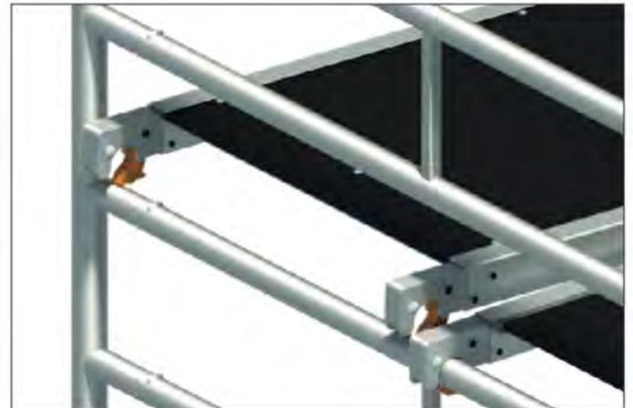
Die **orangenen** Schließbügel der Böden ermöglichen durch ihre speziell dafür gestaltete Geometrie den mühelosen Ein- und Ausbau durch eine Person; sie sind zuerst zu lösen und der Belag mit den geöffneten Bügeln auf die Sprosse aufzulegen, dann erst werden die gegenüberliegenden Bügel gelöst und der Belag ausgehoben.
