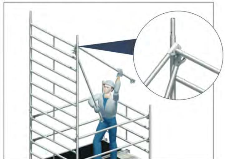
13. Demontage der Geländer 5 durch öffnen der Einrastklaue mithilfe von einem der zuvor demontierten Geländer. Das lose Geländer 5 wird auf die 2. Sprosse von oben aufgelegt und wirkt als Hebel zum Öffnen des Schließbügels der Einrastklaue (siehe Detail).
