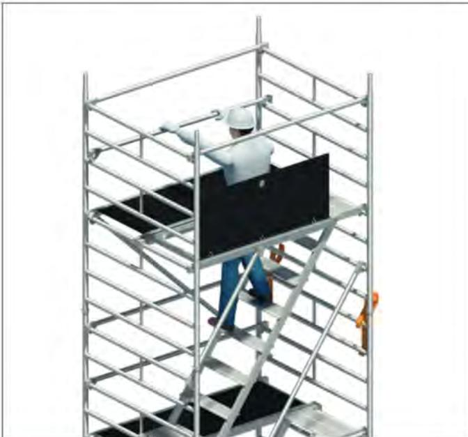
13. Aufstieg über die Stufen der Podesttreppe 8 durch die dafür vorgesehene Durchstiegsklappe. In der Durchstiegsöffnung, auf der Treppe stehend, absturzgesichert durch die Holme der Treppendurchstiegsbrücke 10 erfolgt die Montage der Zwischengeländer der nächsten Lage, hierzu werden die Geländer 5 jeweils an den zweiten Sprossen über der Standfläche montiert.
