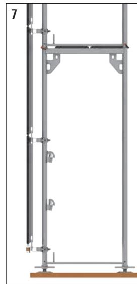
3. Einhängen der Wandkassetten oder Lichtkassetten in die montierten Blitz Gerüst-Halter.
