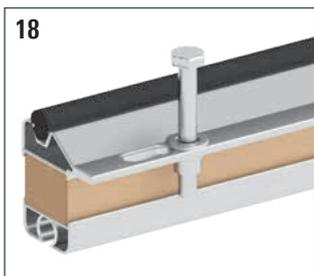
Die Anschlussschienen haben ein kurzes Langloch und daneben eine Einnietmutter mit Schraube. Bei horizontaler Montage ist die Schraube parallel zu den Bolzen des Gerüst-Halters und wie diese im Langloch der Protect-Kassette zu befestigen. Im vertikalen Montagezustand wird die Anschlussschiene ausschließlich mit den mitgelieferten Schrauben in den Langlöchern der Wandkassetten bzw. Lichtkassetten befestigt.
