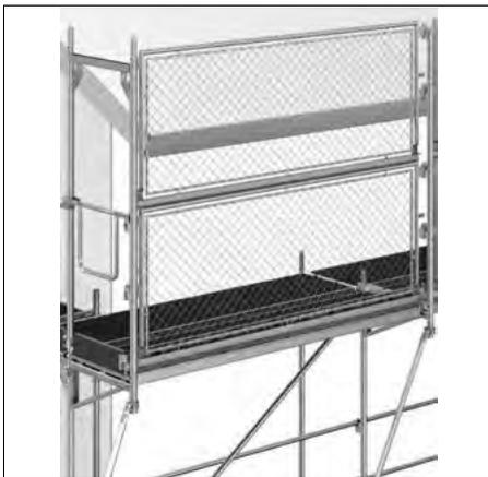
*Bild 3-14: Schutzwand mit Seitenschutzgitter auf
