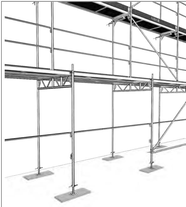
*Bild 3-1: Unterste Lage mit Durchgangsrahmen, Grundkonfiguration*
