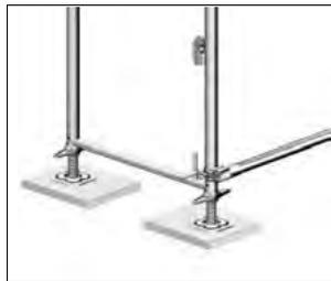
Bild 2-19: Last verteilender Unterbau mit Holzbohlen
