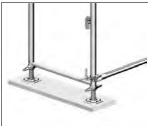
Bild 2-18: Last verteilender Unterbau mit durchgehenden Holzbohlen
