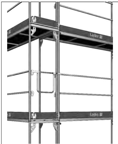
Bild 2-38: Eckausbildung (mit Drehkupplung)
