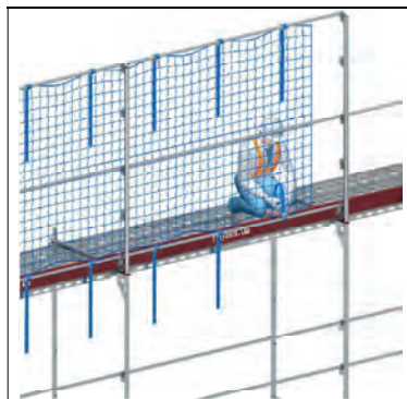
Bild 3-15: Befestigung des Seitenschutznetzes am unteren Geländer/Gerüstrohr
