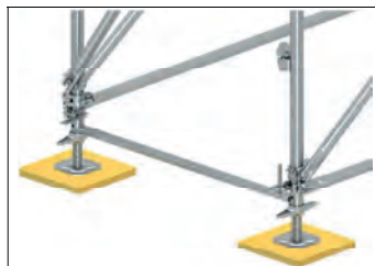
Bild 2-19: Last verteilender Unterbau mit Holzbohlen
