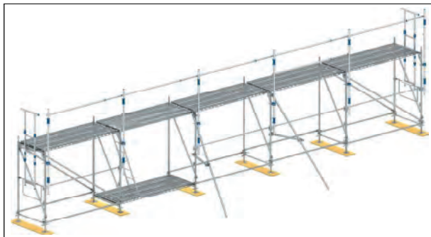
Bild 2-36: Vorübergehende Kippsicherung der 1. Gerüstlage mit Gerüstrohren
