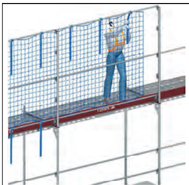
Bild 3-14: Befestigung des Seitenschutznetzes am oberen Geländer/Gerüstrohr
