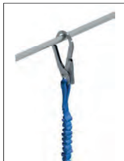
Bild 2-13: Detail Anschlagpunkt 4 oberer Geländerholm
