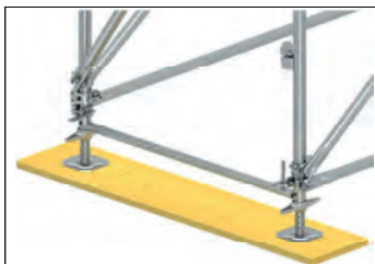
Bild 2-18: Last verteilender Unterbau mit durchgehenden Holzbohlen
