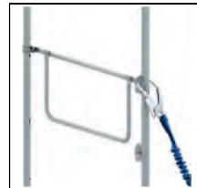
Bild 2-17b: Detail Anschlagpunkt 6 Doppelstirngeländer am Geländerkästchen
