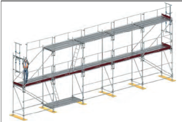
Bild 2-32: Montage der Gerüstfelder (II)
