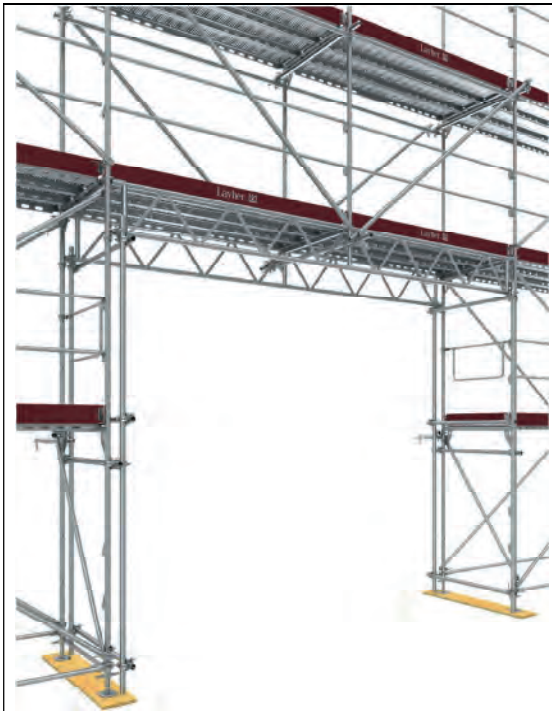
Bild 3-2: Überbrückung 6,14 m, Beispiel: Grundkonfiguration, unbekleidet
