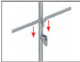
Bild 2-4: Einsetzen der Geländer
