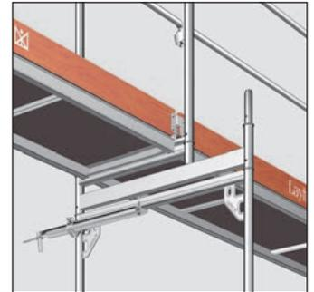
Bild 122: Verwendung Reduzierstück
