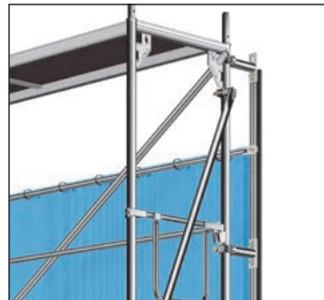
Bild 144: Aufbaubeispiel Kederplanensystem
