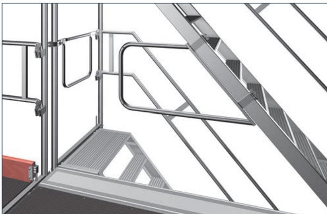
Bild 71: Durchgehende Belagsfläche am Übergang von Treppe zu Gerüst
