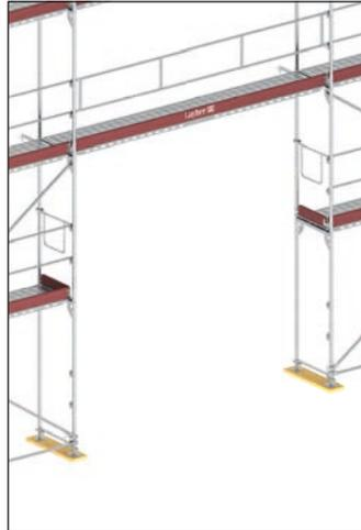
Bild 115: Überbrückung mit 4,14 m Stahlboden LW
