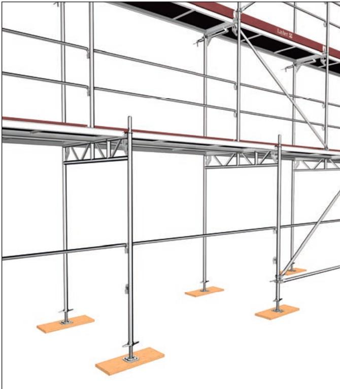
Bild 120: Einbau Durchgangsrahmen
