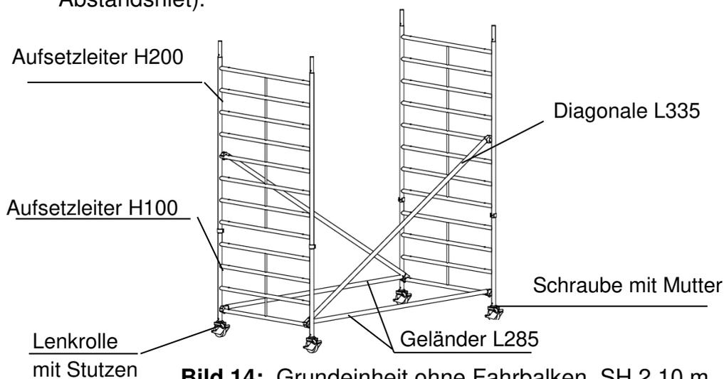
**Bild 14:** Grundeinheit ohne Fahrbalken, SH 2.10 m
