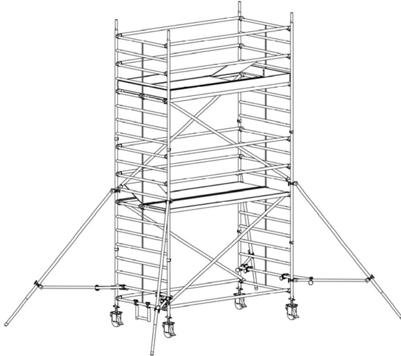
**Bild 18:** Aufbau mit Alu-Gerüststütze, Standhöhe 2.25 m
