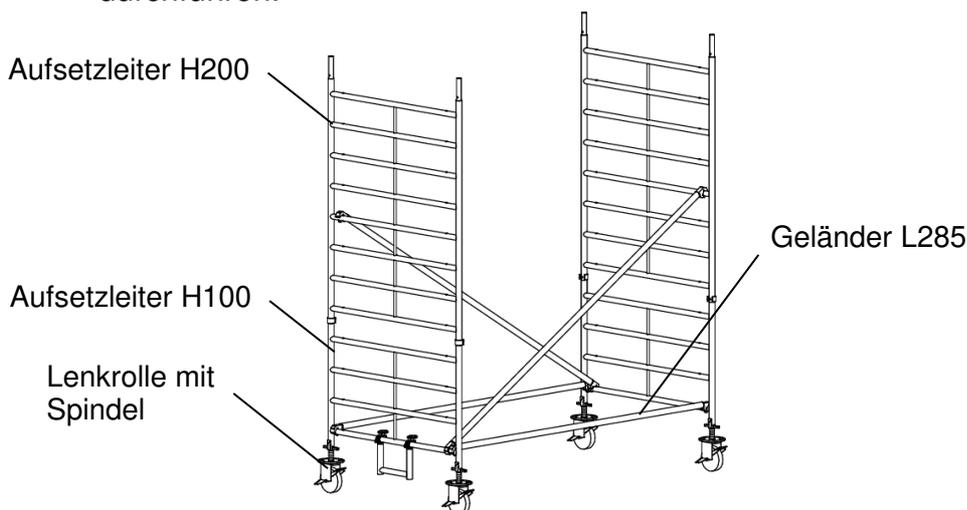
**Bild 4:** Grundeinheit ohne Fahrbalken, Standhöhe 4.25 m
