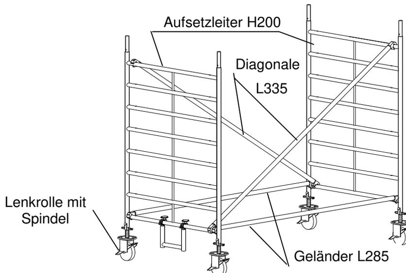
**Bild 17:** Grundeinheit ohne Fahrbalken, Standhöhe 5.25 m
