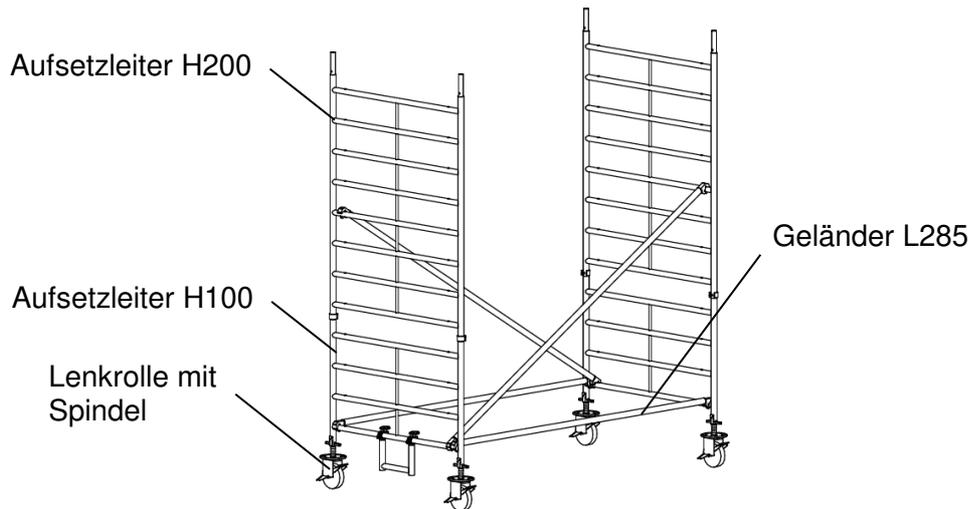
**Bild 16:** Grundeinheit ohne Fahrbalken, Standhöhe 4.25 m
