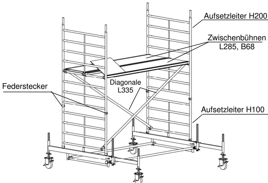
**Bild 9:** Zwischenbühne Standhöhe 2.45 m
