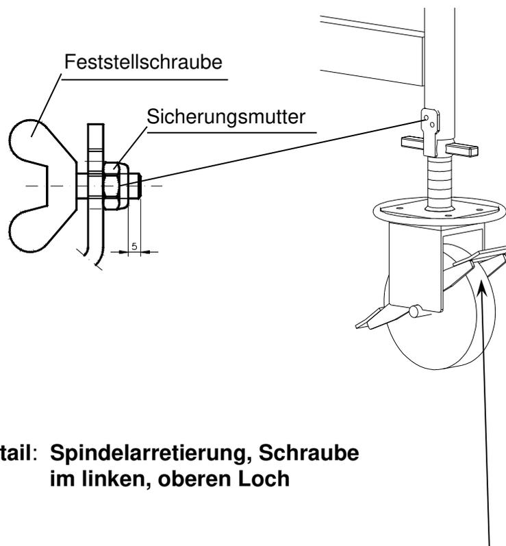
**Detail: Spindelarreterung, Schraube im linken, oberen Loch**
