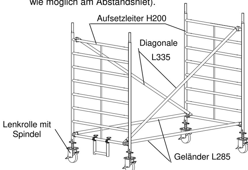
**Bild 5:** Grundeinheit ohne Fahrbalken, Standhöhe 5.25 m
