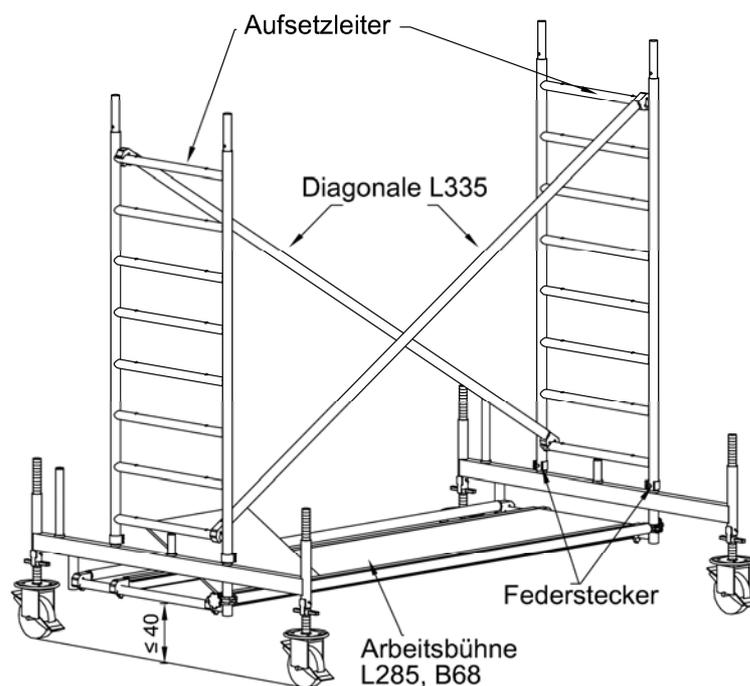
**Bild 4:** Grundeinheit mit Fahrbalken L180 – mittige Stellung
