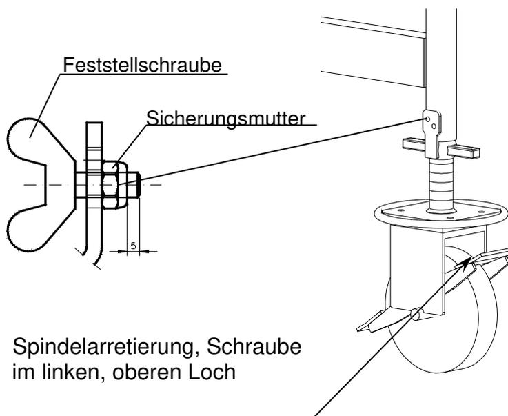
**Detail:** Spindelarretierung, Schraube
