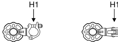
Für die einzelne Keilkopfkupplung gilt:      zul H1 =  $14.5 / 8.8 = \underline{1.7 \text{ kN}}$
