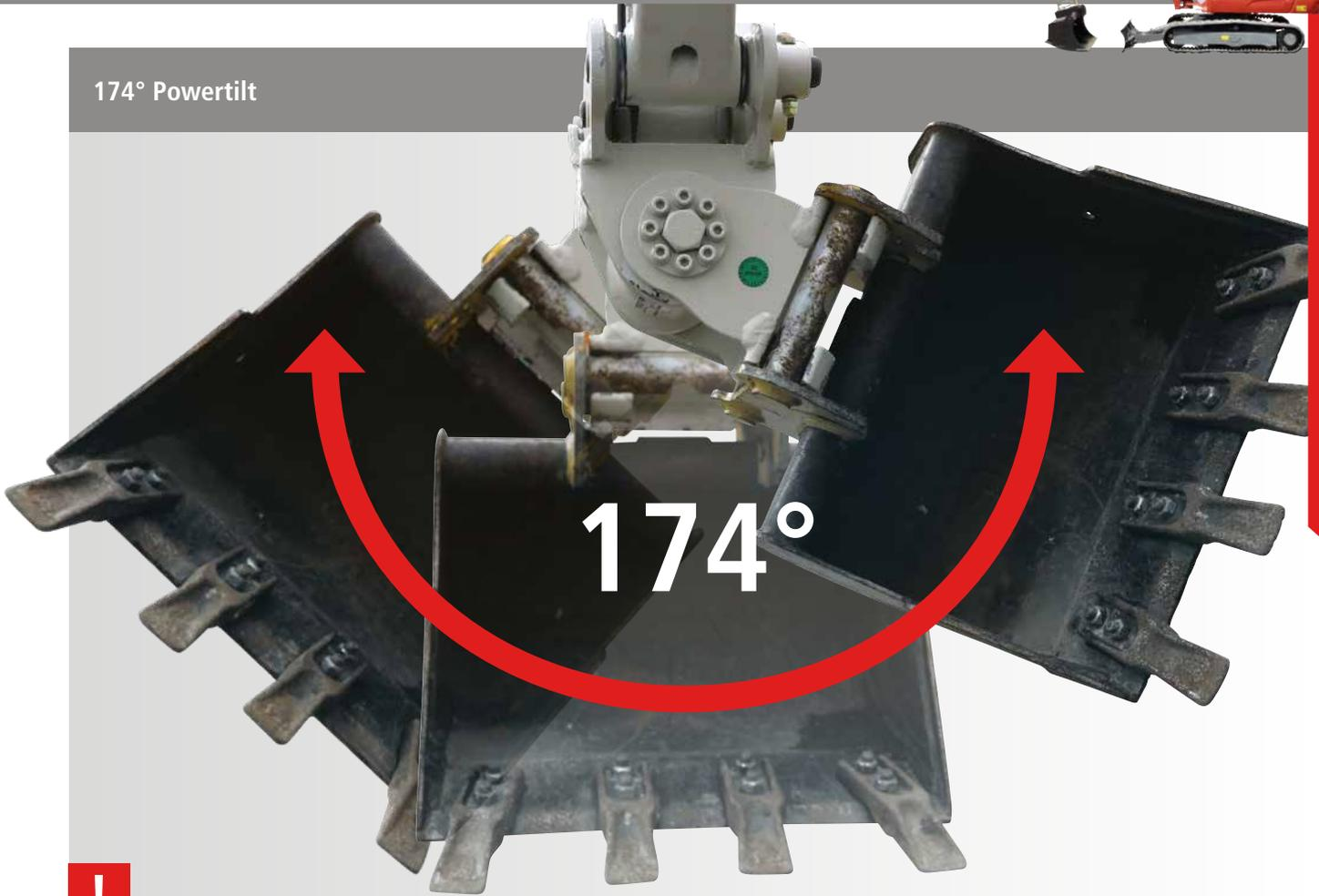
Fast alle unsere Bagger haben jetzt hydraulische **Schnellwechsler** und **Schwenkmotoren** über den Löffeln.
