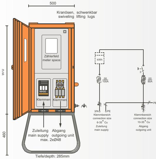
Anschlusschrank M-A 250-A mit allstromsensitivem Schutzschalter
