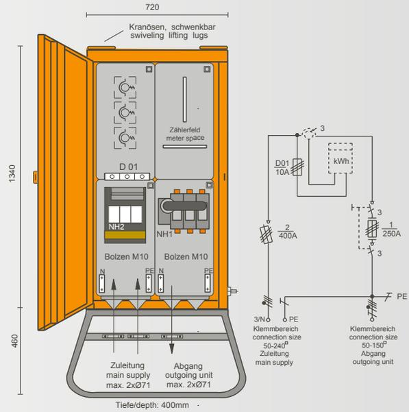
Anschlussverteilerschrank M-AVEV 63/211-6/N/2/X mit allstromsensitivem Schutzschalter
