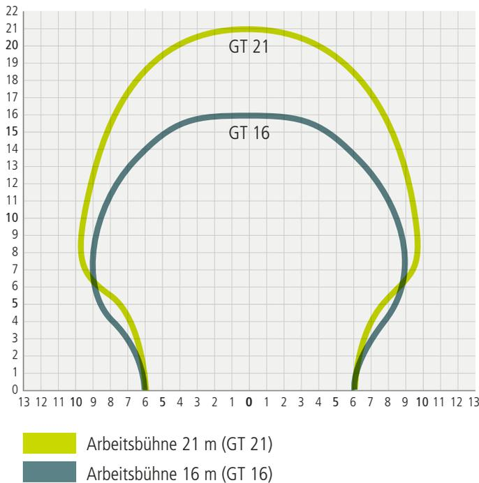
Belastungsdiagramm für Arbeitsbühnen auf Kettenfahrwerk
